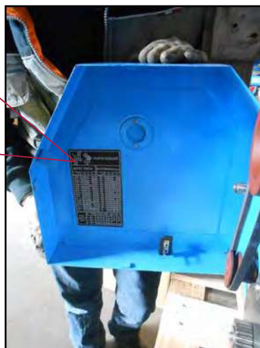
Figura 24 – Tabella filettature a avanzamenti automatici.
