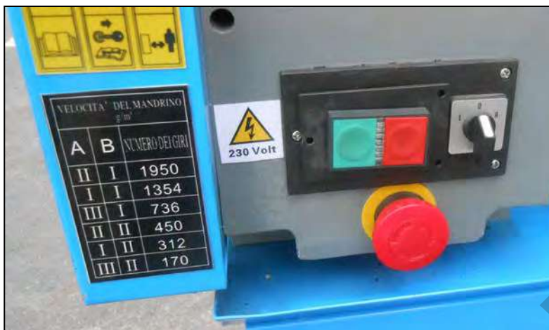
Figura 7 – Quadro elettrico e di comando.
