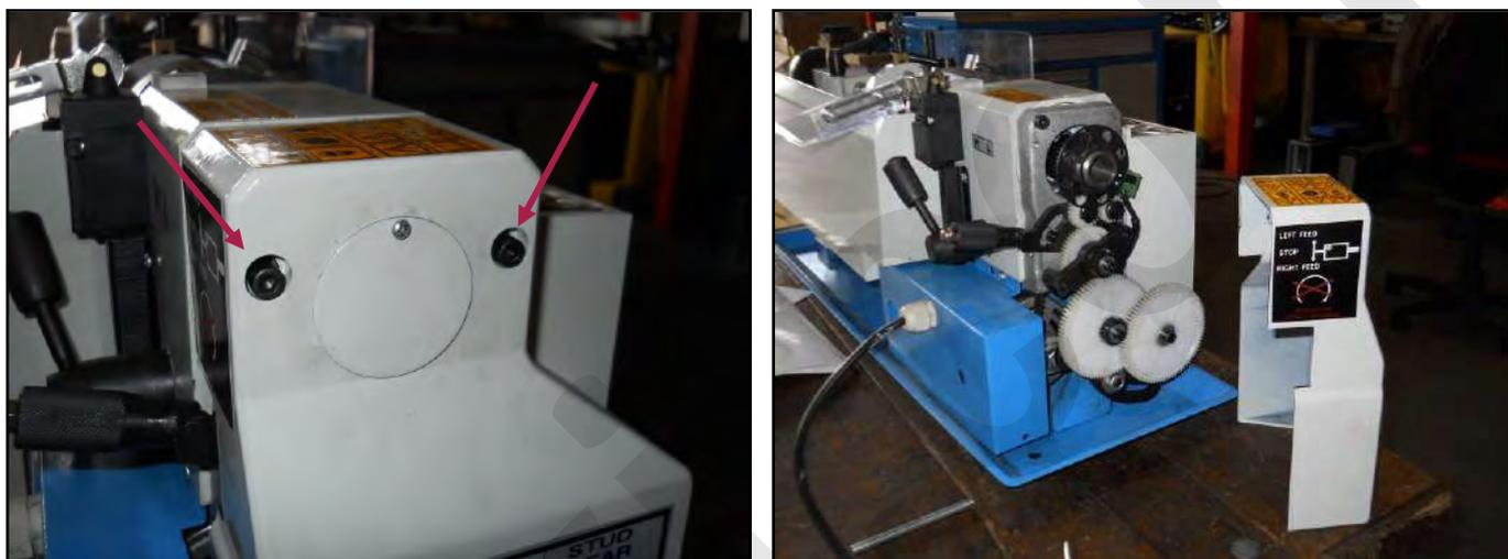
Figura 26 – Rimozione del carter di protezione.
