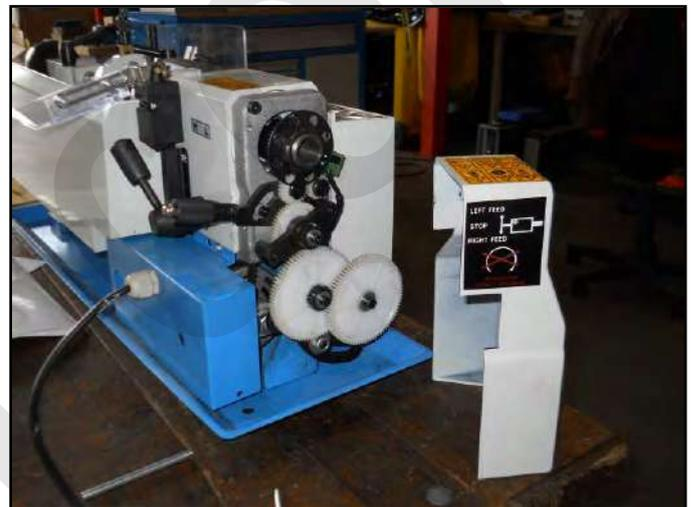
Figura 24 – Rimozione del carter di protezione.
