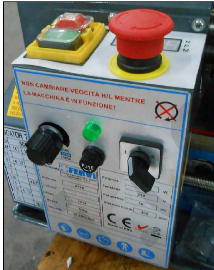
Figura 8 – Quadro di comando.
