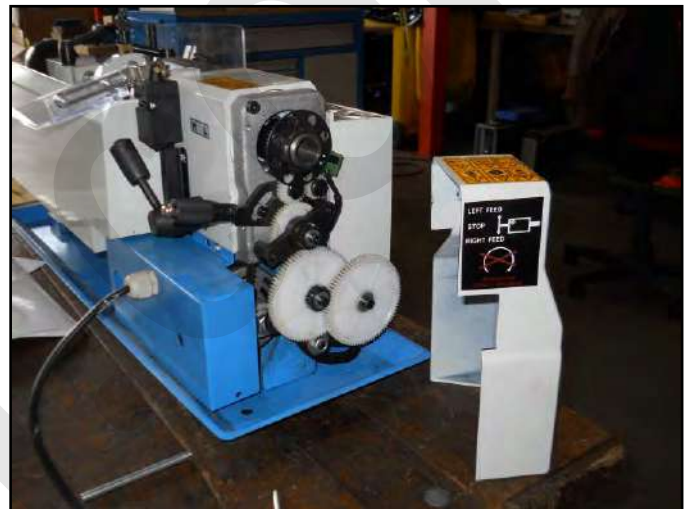
Figura 24 – Rimozione del carter di protezione.
