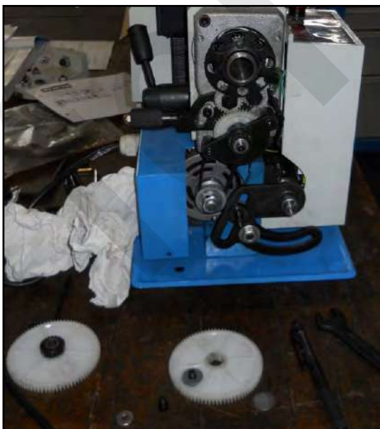
Figura 25 – Rimozione delle ruote dentate.
