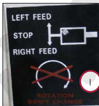
Figura 13 – Targa leva selettore velocità.
