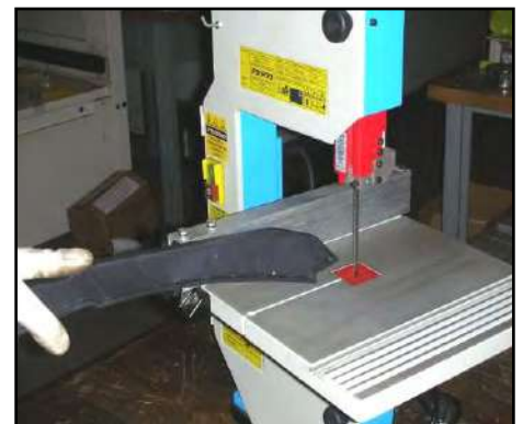
Figura 10 – Dettaglio leva spingi-pezzo.
