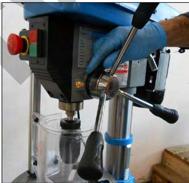
Figura 32 – Regolazione profondità foratura
