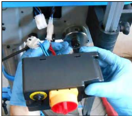
Figura 7 - Fasi del montaggio del quadro
