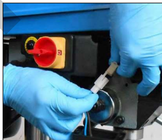
Figura 10 - Collegamento delle connessioni
