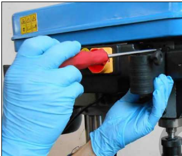
Figura 11 – Montaggio del blocco microinterruttore
