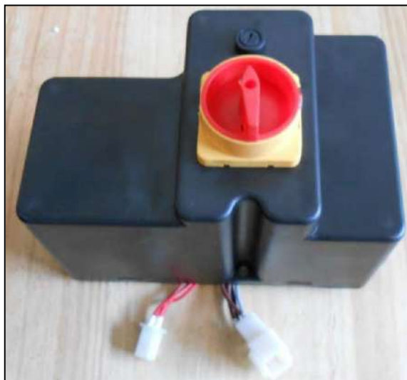
Figura 36 –Interruttore termico posto all'interno del quadro
