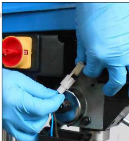
Figura 10 – Montaggio blocco microinterruttore
