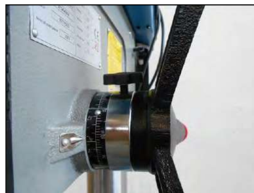
Figura 25 – Vite di regolazione profondità foratura
