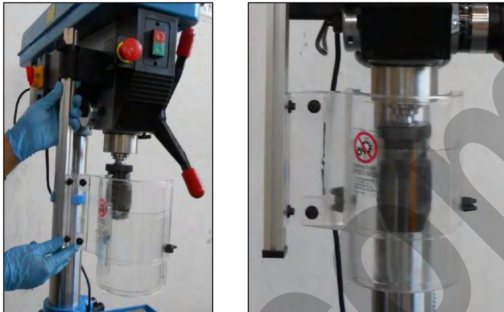
Figura 17 – Inserimento della staffa e posizionamento corretto del riparo
