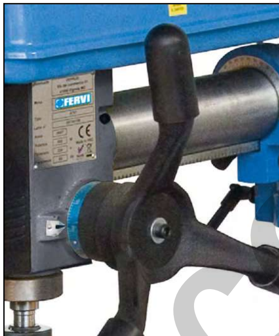
Figura 16 – Volanti di discesa del mandrino.
