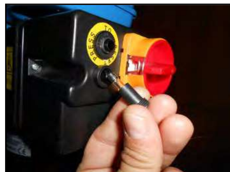
Figura 19 – Fusibile di protezione.
