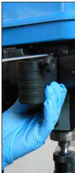
Figura 5 – Montaggio del blocco microinterruttore
