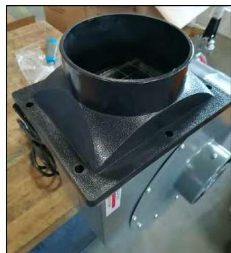
Figura 10 – Montaggio del collettore di uscita.
