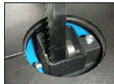
Figura 25 – Dettaglio guida lama inferiore.
