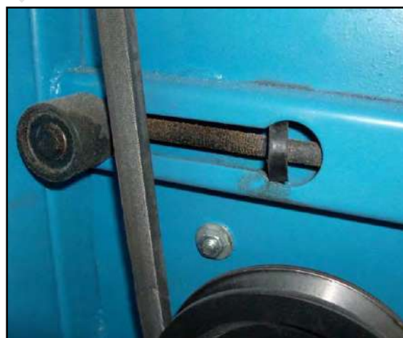
Figura 39 – Regolazione della tensione della cinghia.
