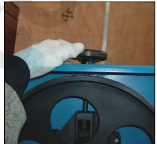
Figura 10 – Regolazione della tensione della lama.
