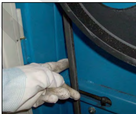
Figura 37 – Cinghia di trasmissione della sega.
