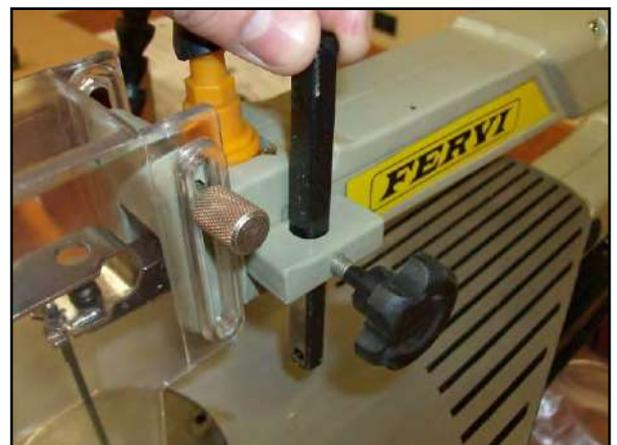
Figura 9 – Montaggio asta di sostegno forcella.
