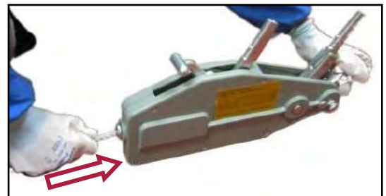
Figura 8 – Inserimento della fune d'acciaio.
