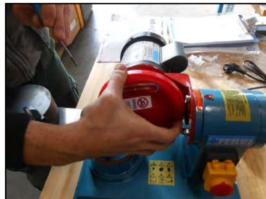
Figura 17 – Rimozione del carter di protezione della mola.
