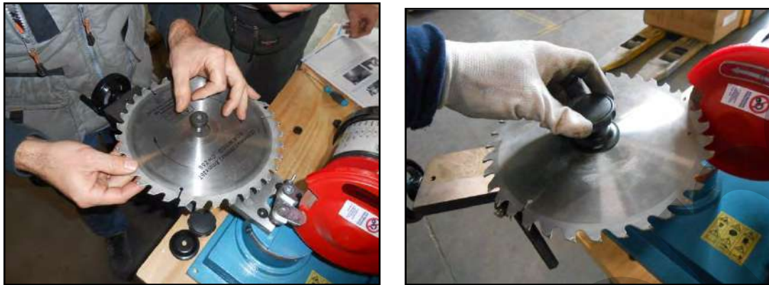
Figura 9 - Montaggio del disco.
