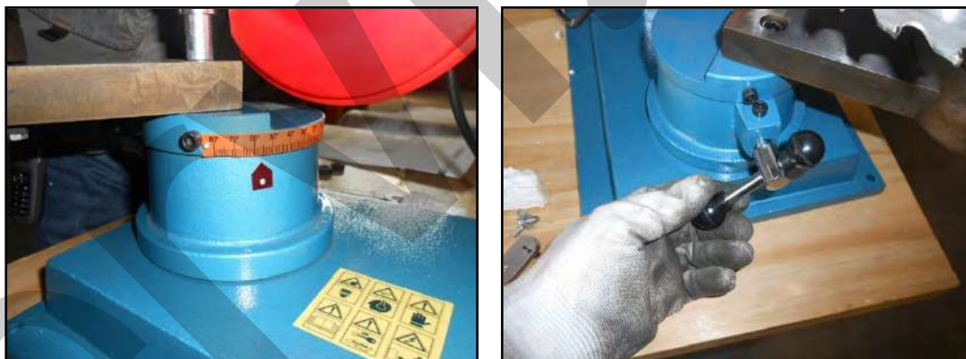
Figura 10 - Regolazione e blocco del supporto girevole.
