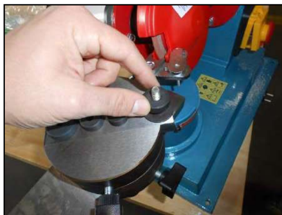
Figura 8 – Montaggio della boccia.
