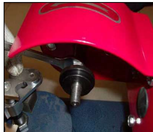
Figura 20 - Rimozione della mola.
