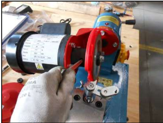
Figura 18 - Smontaggio del dado di blocco.
