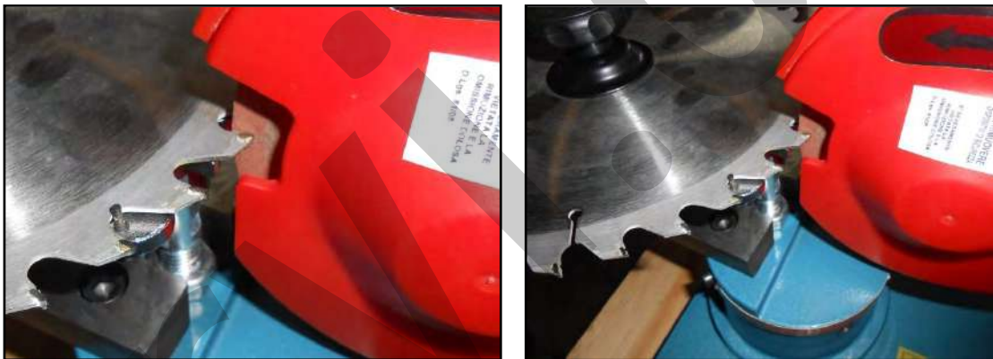
Figura 12 - Regolazione del supporto di riscontro.
