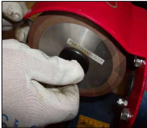
Figura 19 - Rimozione del dado e della flangia.
