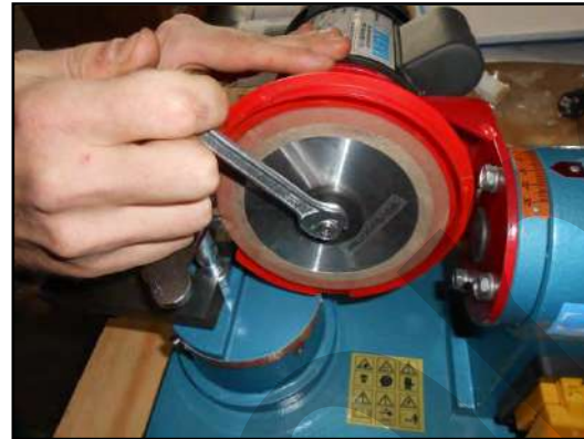
Figura 18 - Smontaggio del dado di blocco.
