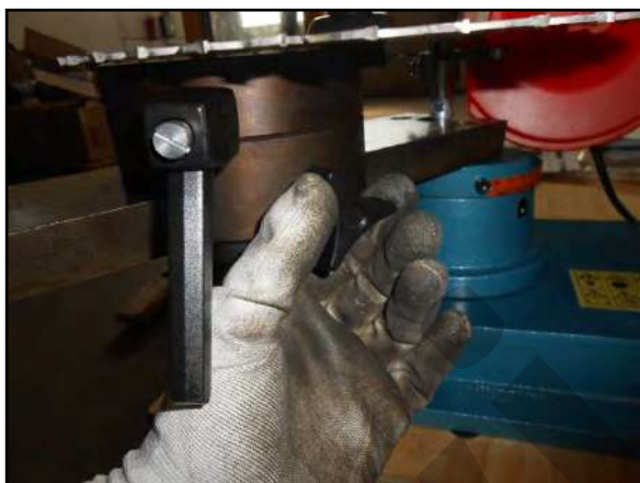
Figura 7 – Posizionamento del supporto circolare.
