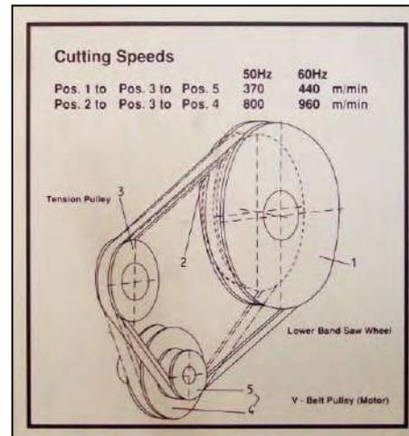
Figura 24 – Pulegge per cambio velocità.
