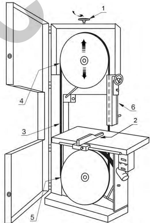
Figura 37 – Sostituzione della lama.
