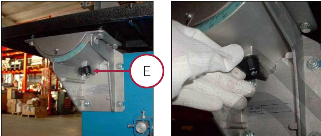
Figura 13 – Manopola di bloccaggio inclinazione tavola.
