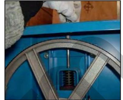
Figura 11 – Regolazione tensione lama.
