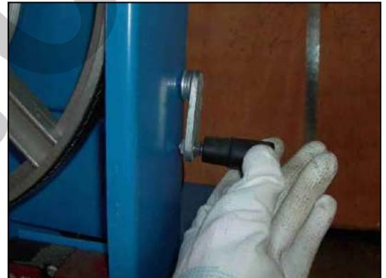
Figura 26 – Allentamento della cinghia di trasmissione.
