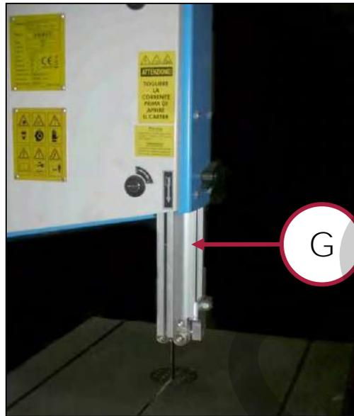
Figura 15 – Carter regolabile di protezione lama.
