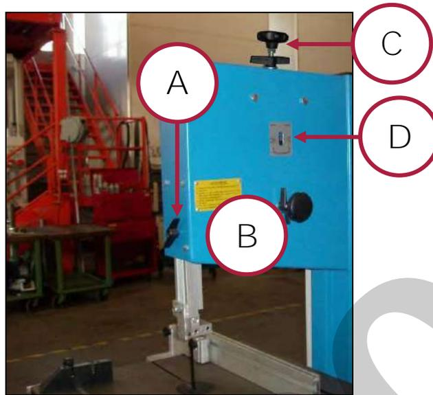
Figura 9 – Volantini e pomelli lato motore.
