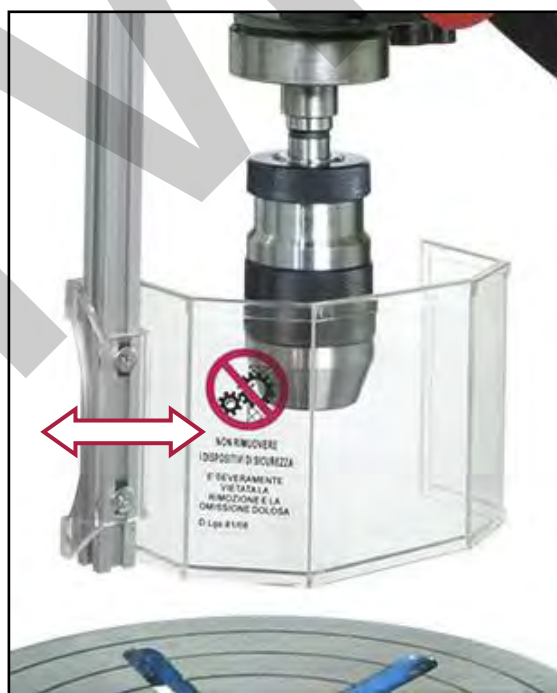
Figura 9 - Scorrimento del riparo in senso longitudinale
