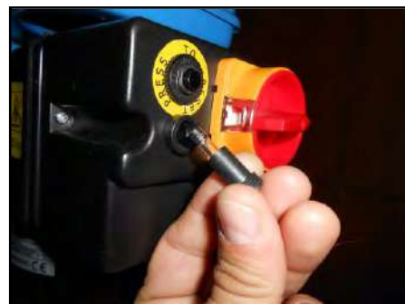
Figura 19 – Fusibile di protezione.
