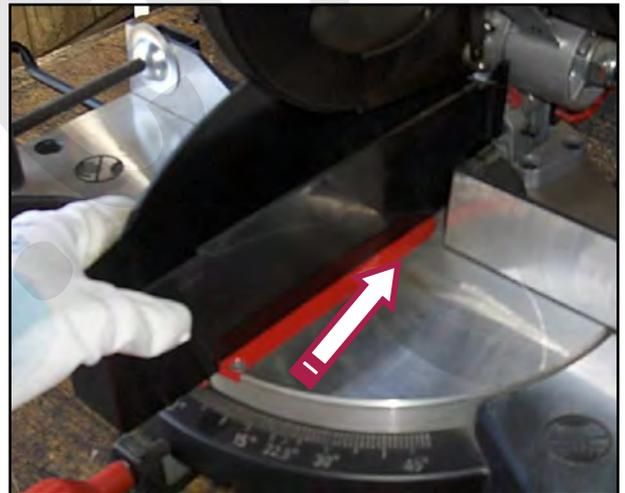
Figura 8 – Protezione inferiore in posizione.
