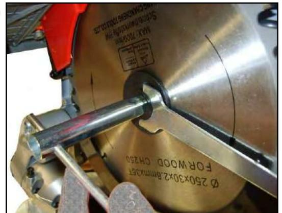
Figura 35 – Smontaggio lama.
