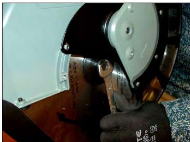
Figura 31 – Rimozione del dado di blocco.
