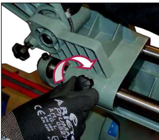
Figura 23 – Rotazione pomello di blocco avanzamento radiale.
