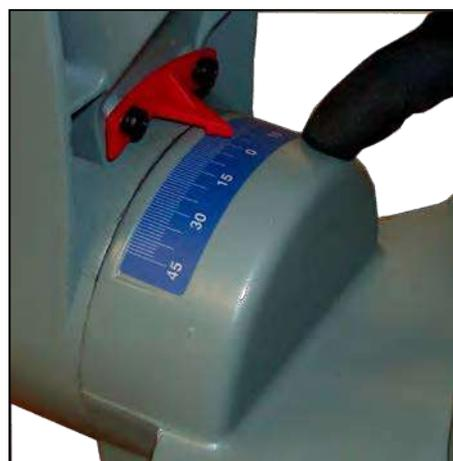
Figura 19 – Regolazione dell'inclinazione in posizione qualsiasi.
