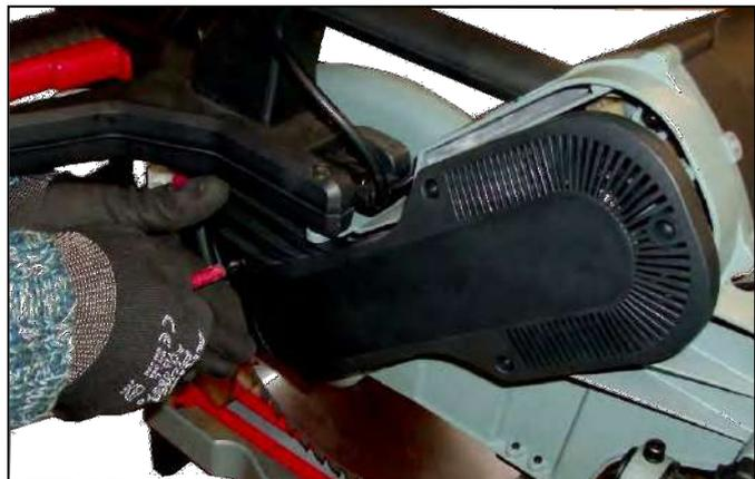
Figura 28 – Rimozione del carter di protezione della cinghia.
