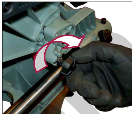
Figura 21 – Rotazione del pomello di blocco.
