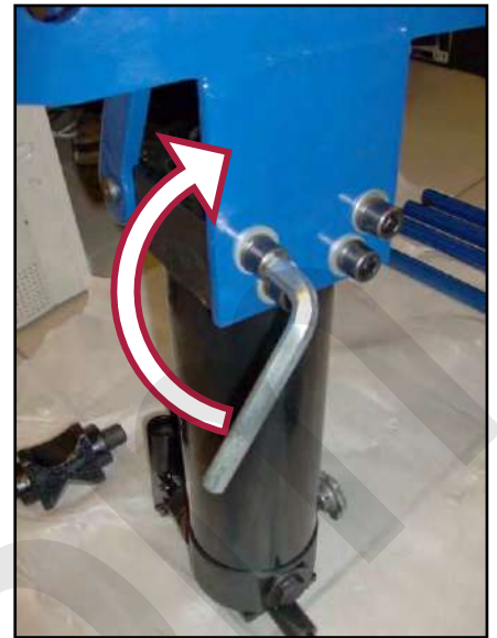
Figura 9 – Serraggio dei bulloni.
