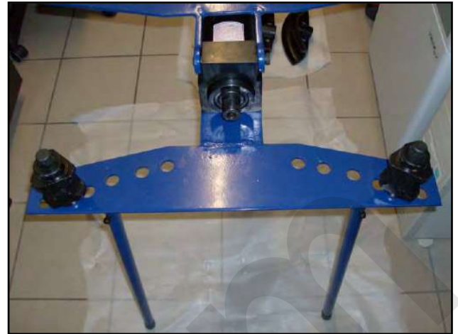
Figura 15 – matrici mobili inserite.
