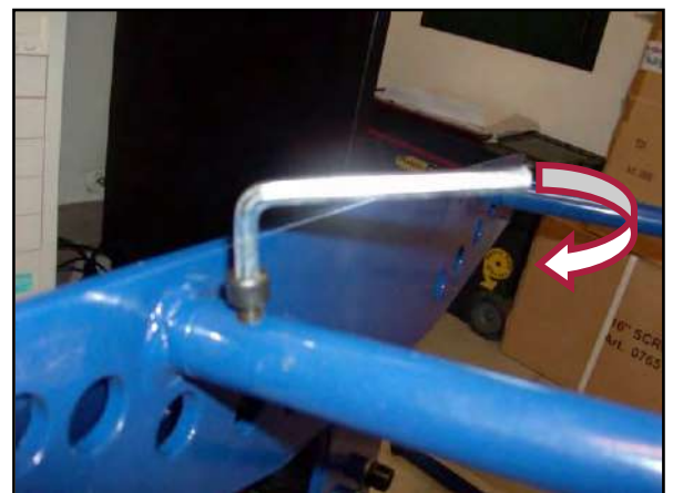
Figura 11 – Serraggio bulloni di fissaggio piedi d'appoggio.
