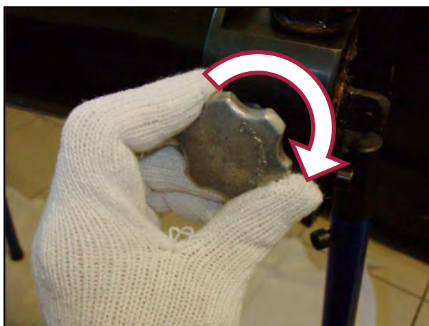
Figura 24 – Chiusura della valvola di scarico del cilindro idraulico.
