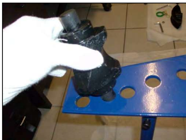
Figura 14 – Inserimento delle matrici mobili.
