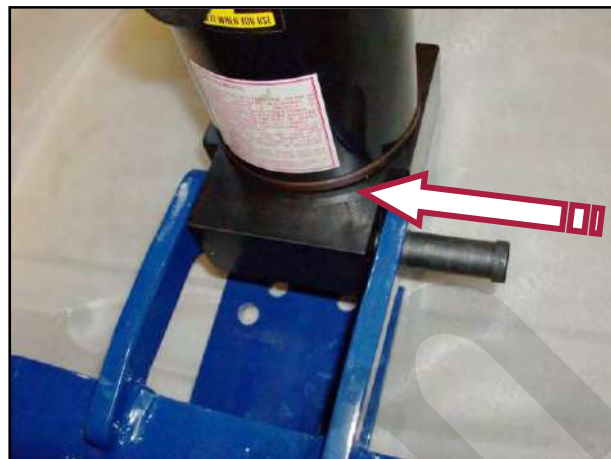
Figura 12 – inserimento perno di fissaggio piastra.
