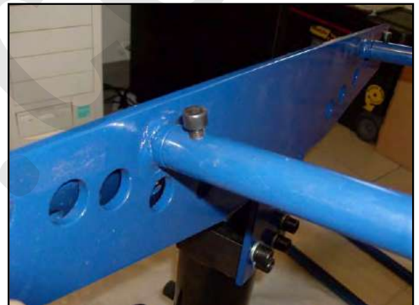
Figura 10 – Inserimento piedi d'appoggio.
