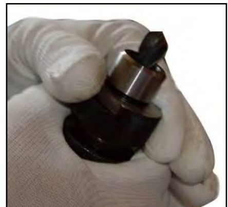
Figura 5 – Inserimento della pinza reggi punta nel canotto.
