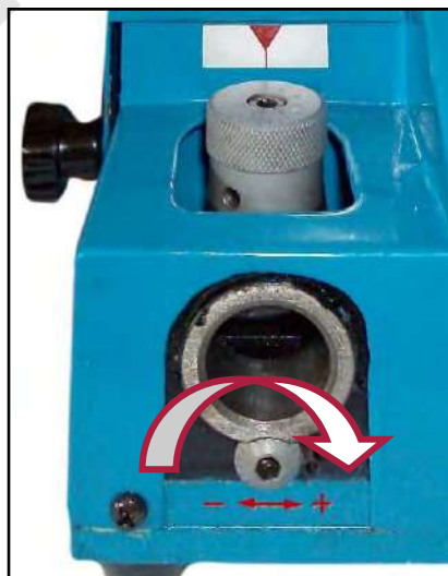
Figura 8 – Regolazione lunghezza affilatura.
