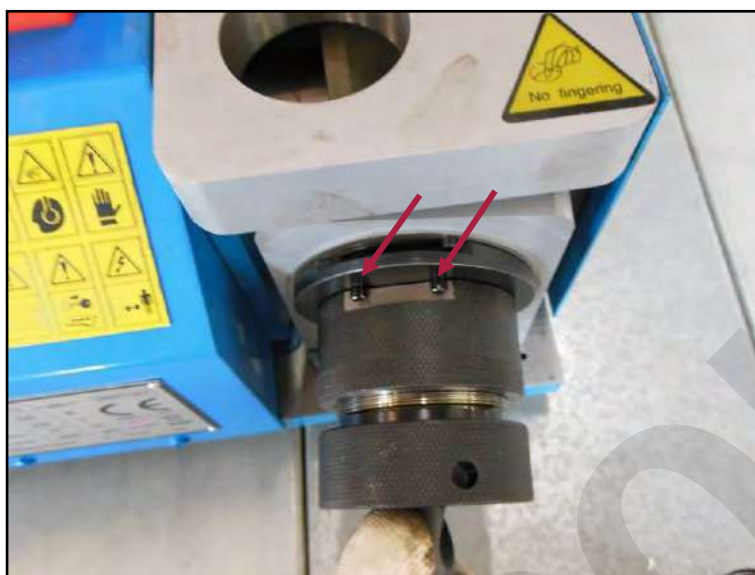
Figura 11 – Affilatura del secondo tagliente.
