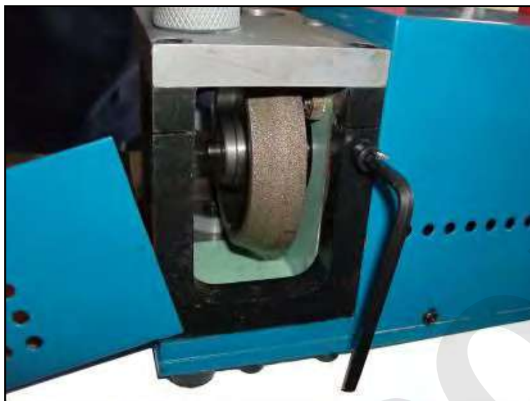
Figura 18 – Apertura carter di protezione.
