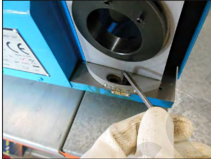
Figura 9 – Impostazione dell'angolo di affilatura.
