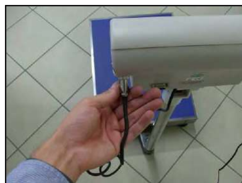
Figura 6 – Collegamento cavo dati.
