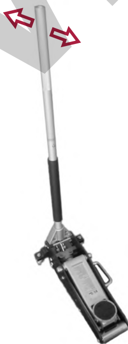
Figura 11 – Movimento leva per pompaggio.
