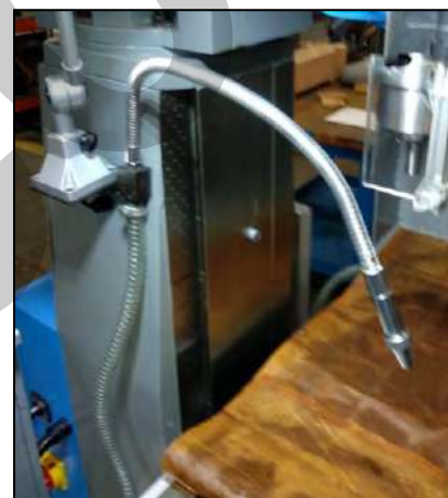
Figura 21 – Rubinetto di uscita del fluido refrigerante.
