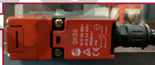
Figura 23 – Carter interbloccato di protezione della tavola portapezzo.
