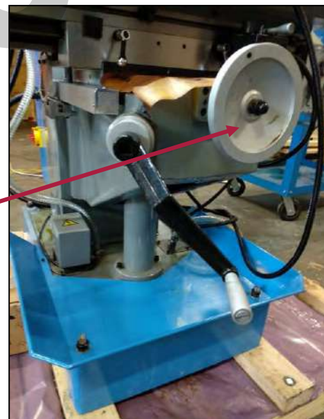
Figura 13 - Volantino per la movimentazione radiale della tavola.
