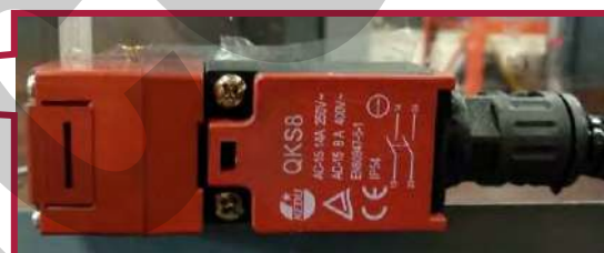
Figura 23 – Carter interbloccato di protezione della tavola portapezzo.
