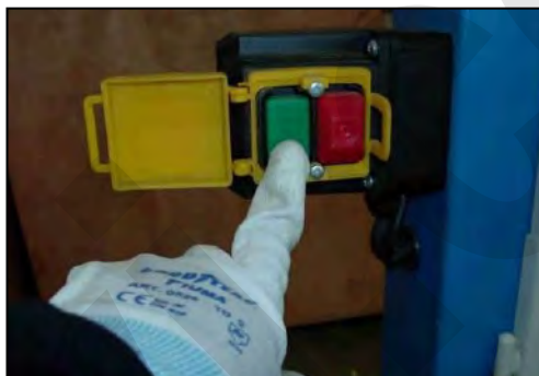
Figura 23 – Avviamento della sega.
