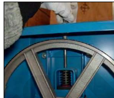
Figura 9 – Regolazione tensione lama.
