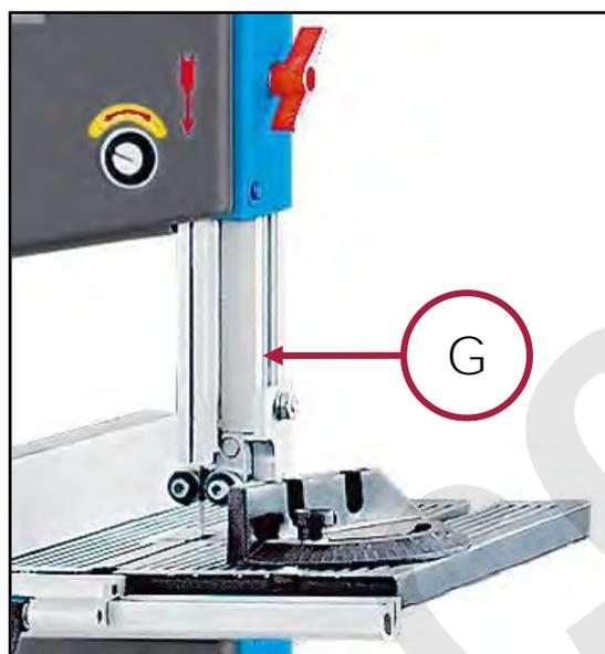
Figura 12 – Carter regolabile di protezione lama.
