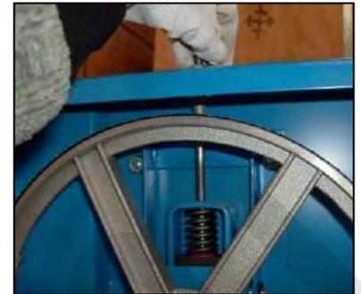
Figura 9 – Regolazione tensione lama.
