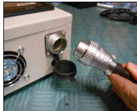
Figura 10 – Connettore e cavo di controllo.
