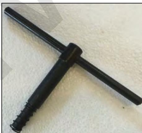
Figura 5 – Chiave dotata di molla di sicurezza
