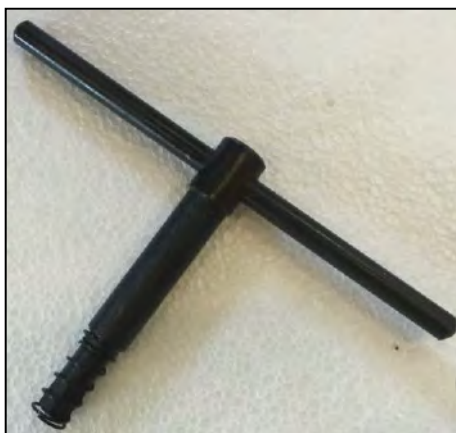
Figura 5 – Chiave dotata di molla di sicurezza
