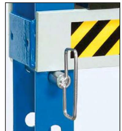
Figura 5 - Perna di bloccaggio del bancale.
