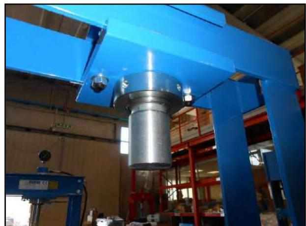
Figura 12 – Montaggio della ghiera inferiore del pistone idraulico.
