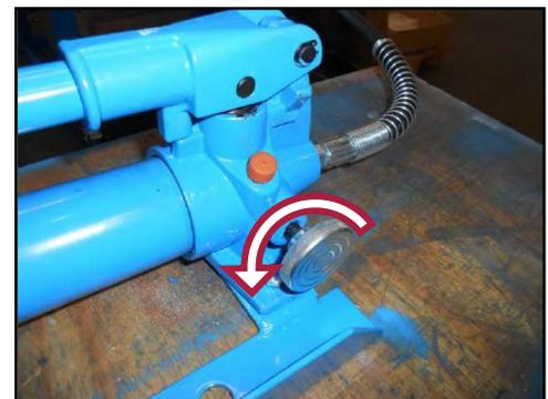
Figura 23 – Valvola di scarico.
