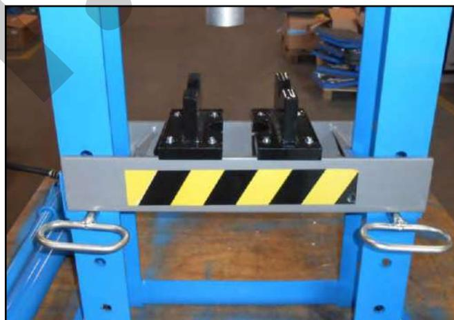
Figura 14 – Montaggio del bancale di pressatura.
