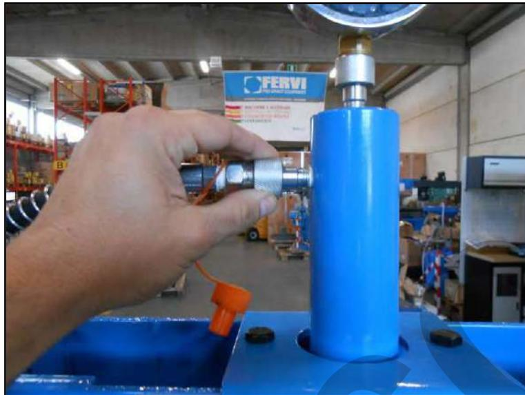
Figura 15 – Montaggio della tubazione idraulica
