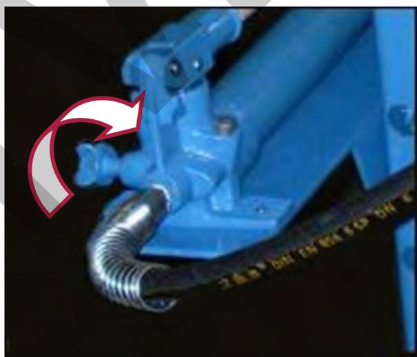
Figura 20 – Valvola di scarico.
