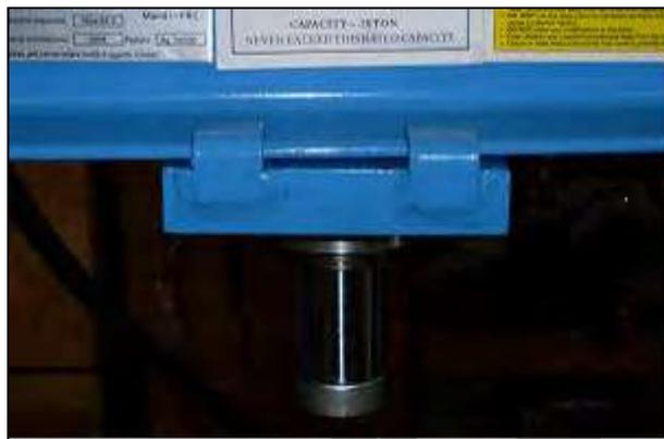
Figura 10 – Montaggio della piastra.
