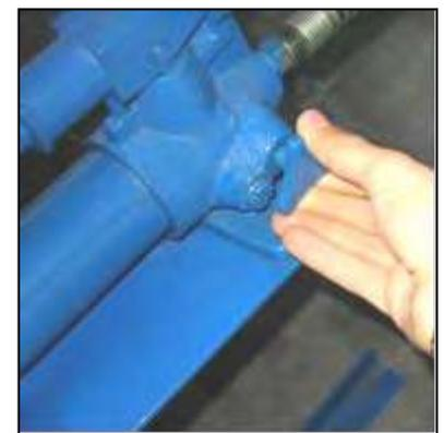
Figura 23 – Valvola di scarico.
