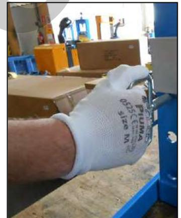
Figura 18 – Estrazione del perno di supporto.
