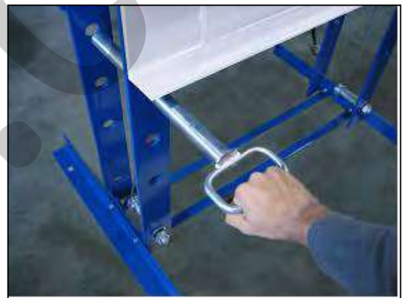
Figura 16 – Estrazione del perno di supporto.
