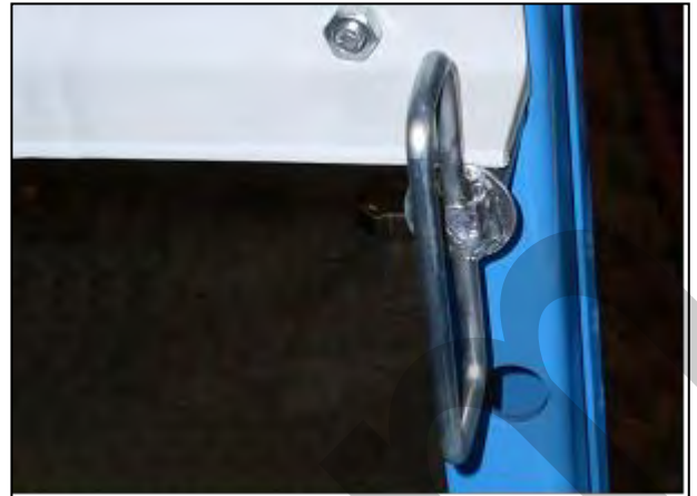
Figura 13 – Inserimento dei perni di sostegno.
