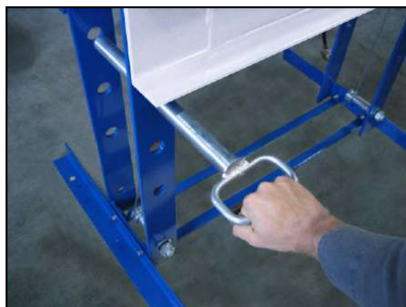
Figura 12 – Estrazione perno di supporto bancale.
