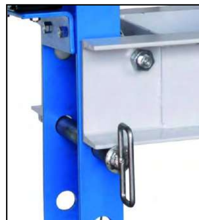
Figura 5 - Perna di bloccaggio del bancale.
