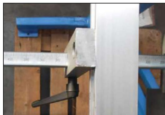
Figura 7 - Leva di bloccaggio della battuta.
