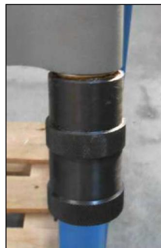
Figura 6 - Pomolo di regolazione dell'altezza del coltello inferiore.
