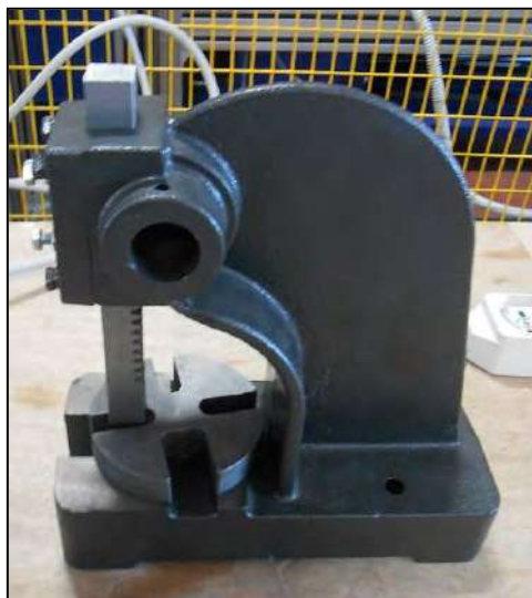
Figura 3 – Inserimento punzone cremagliera e albero pignone
