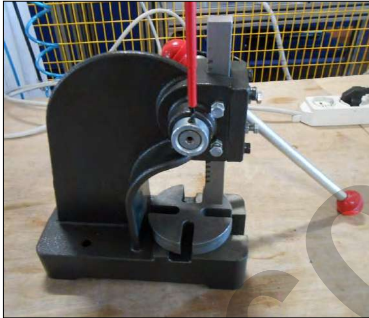
Figura 5: Inserimento e fissaggio ghiera di sicurezza
