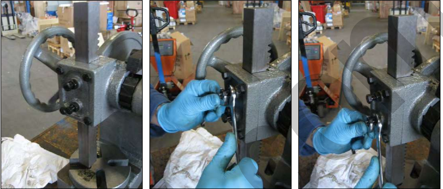
Figura 9 – Regolazione guide scorrimento.
