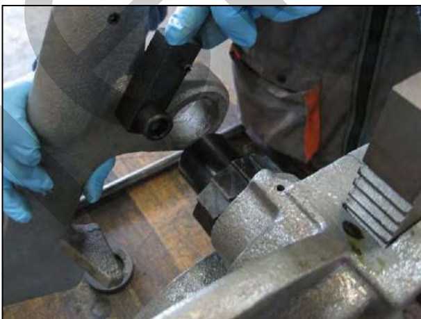
Figura 6 – Montaggio del supporto della leva di pressatura.
