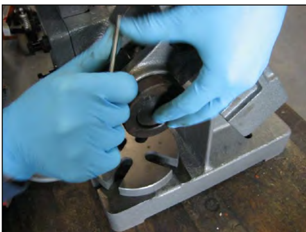
Figura 7 – Montaggio dell'anello di blocco
