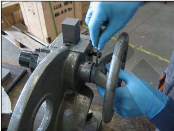
Figura 5 – Montaggio del volantino
