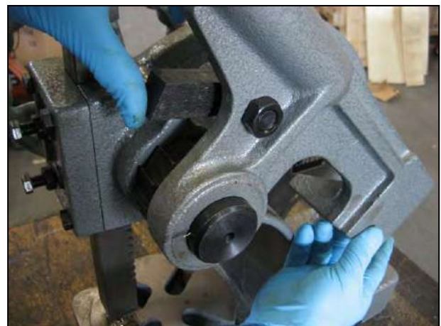
Figura 6 – Montaggio del supporto della leva di pressatura.
