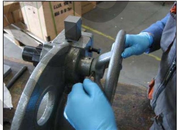
Figura 5 – Montaggio del volantino
