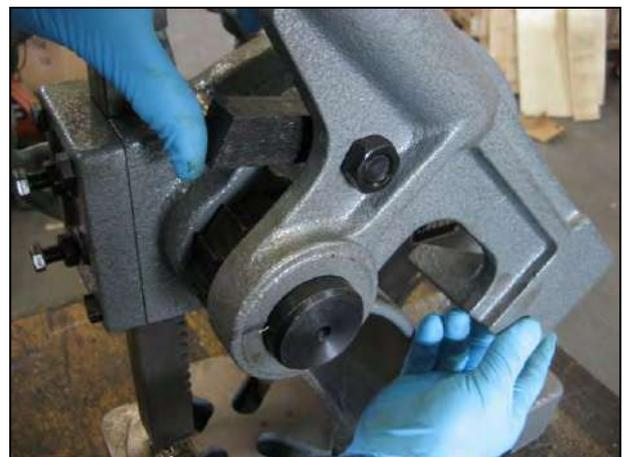
Figura 6 – Montaggio del supporto della leva di pressatura.
