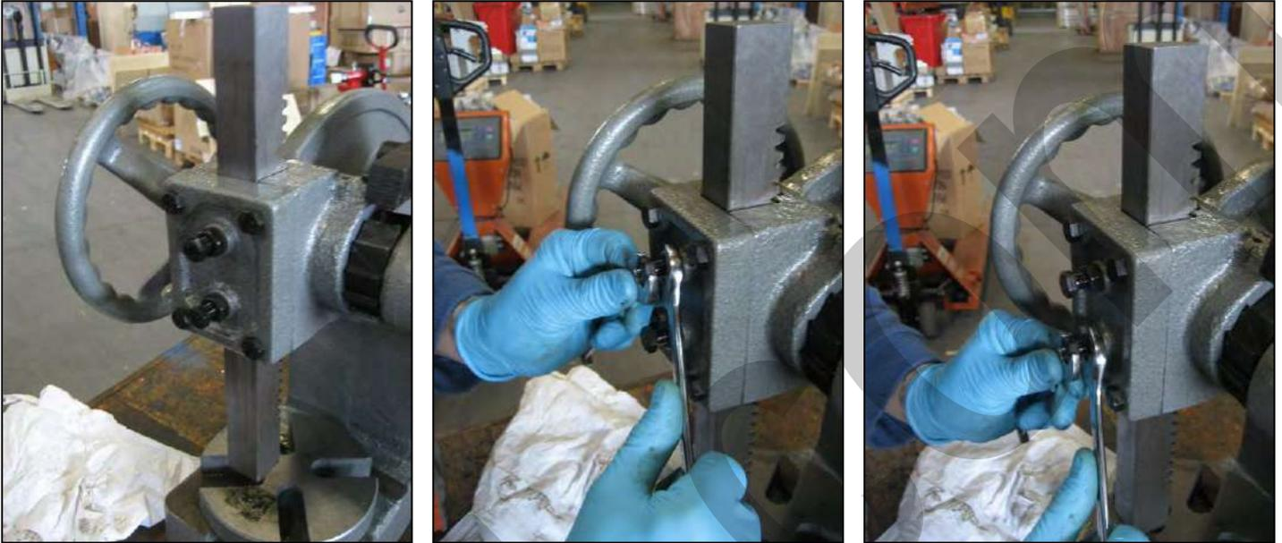
Figura 9 – Regolazione guide scorrimento.
