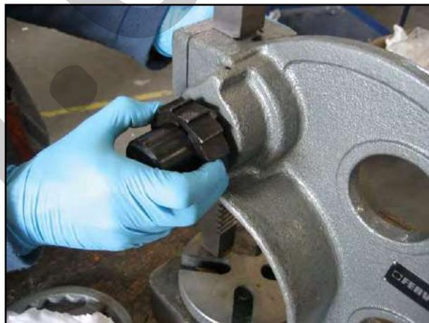
Figura 4 – Inserimento ruota dentata
