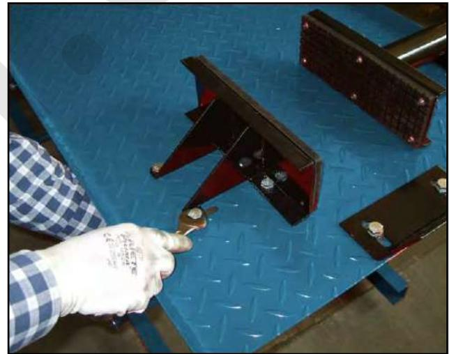
Figura 12 – Montaggio della morsa di bloccaggio ruota.
