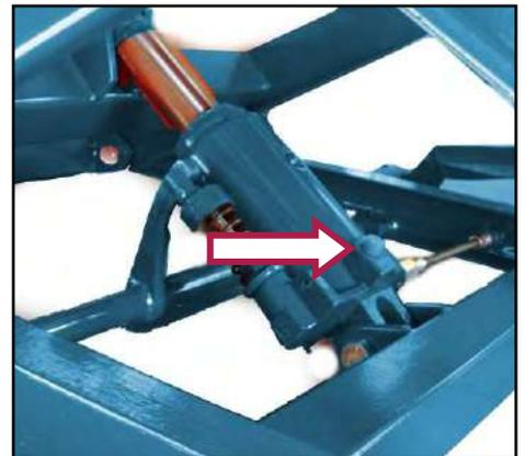
Figura 6 – Dettaglio valvola.
