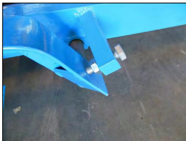
Figura 14 – Regolazione del finecorsa del pedale di pompaggio.
