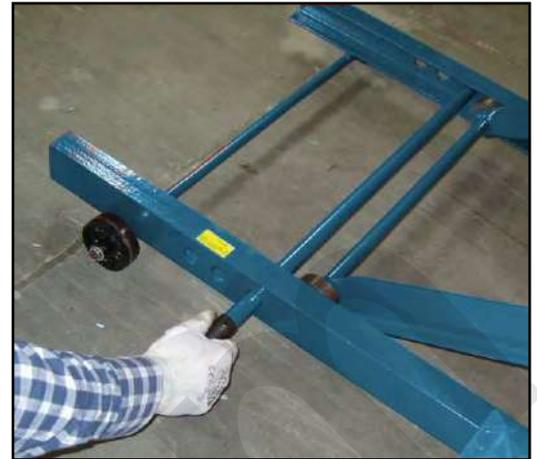
Figura 22 – Inserimento asta di blocco.
