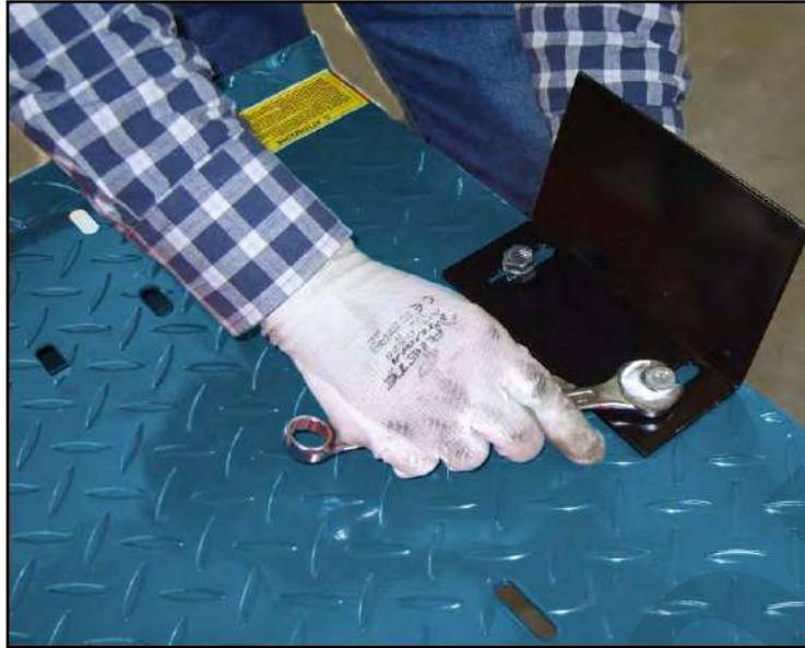
Figura 11 – Montaggio della piastra ferma ruota.
