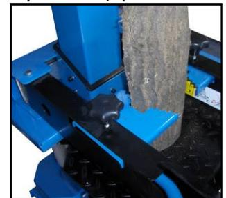
Figura 20 – Posizionamento delle morse.
