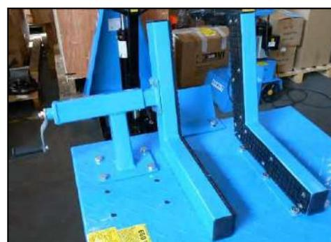
Figura 20 – Montaggio della morsa di bloccaggio ruota.
