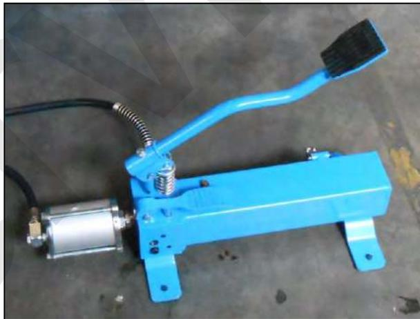
Figura 14 – Installazione del pedale di sollevamento.
