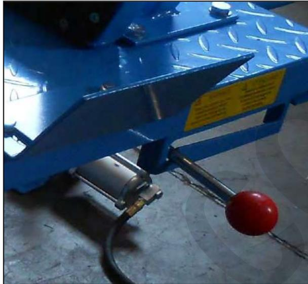
Figura 6 – Dettaglio asta di blocco di sicurezza.
