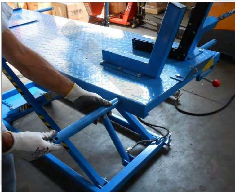
Figura 18 – Installazione delle aste di supporto.
