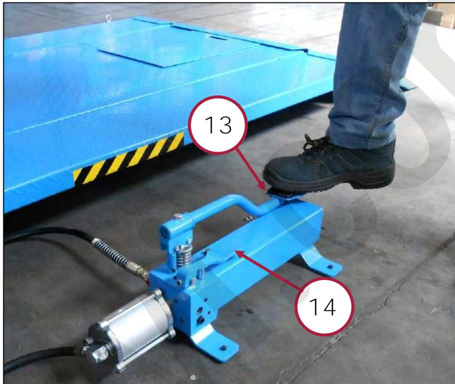
Figura 3 – Dettaglio pedaliera di sollevamento e discesa.
