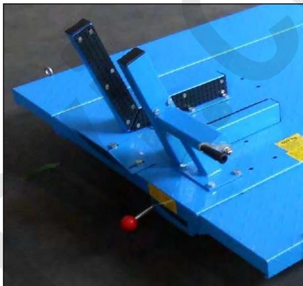
Figura 5 – Dettaglio morsa con manovella per bloccaggio ruota.
