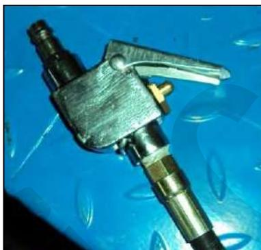
Figura 21 – Leva dell'aria compressa.
