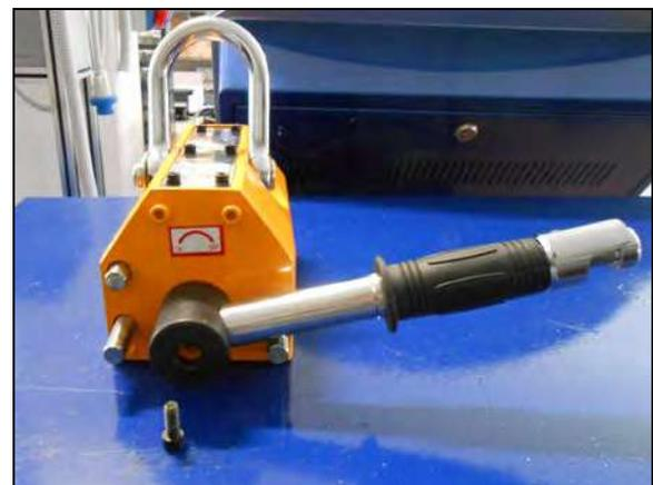
Figura 7– Montaggio maniglia di attivazione.
