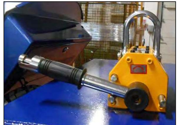
Figura 10– Maniglia in posizione ON , Sollevatore magnetico attivo.
