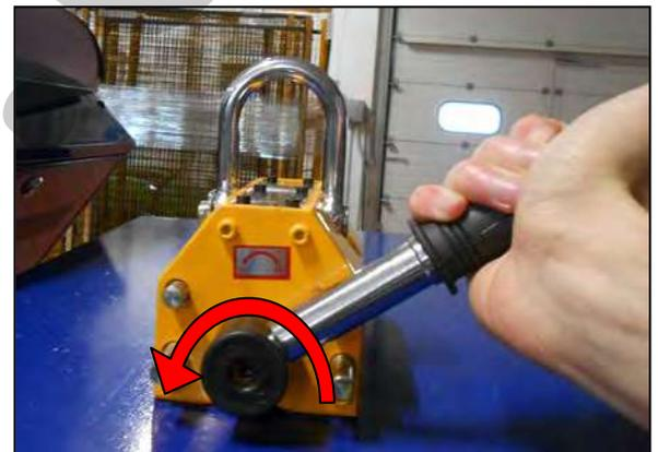
Figura 9– Operazione di attivazione del Sollevatore Magnetico.
