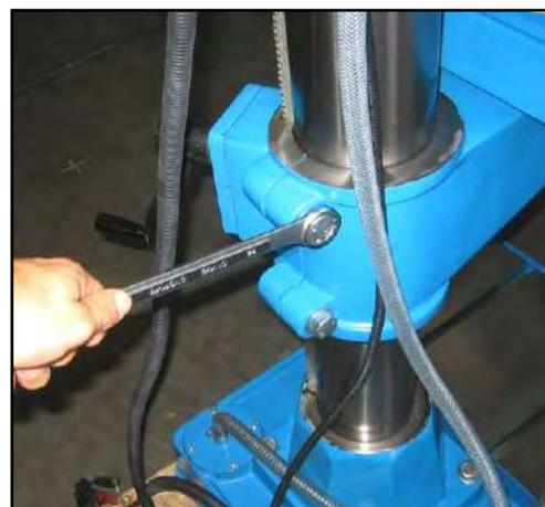
Figura 19 - Sbloccaggio viti
