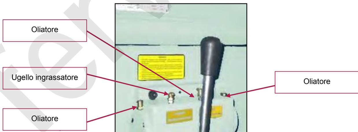
Figura 37 – Testata lato volante
