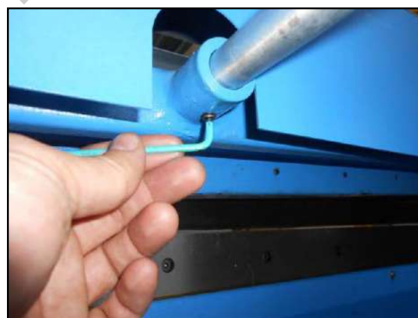
Figura 5 – montaggio dei supporti della battuta posteriore.
