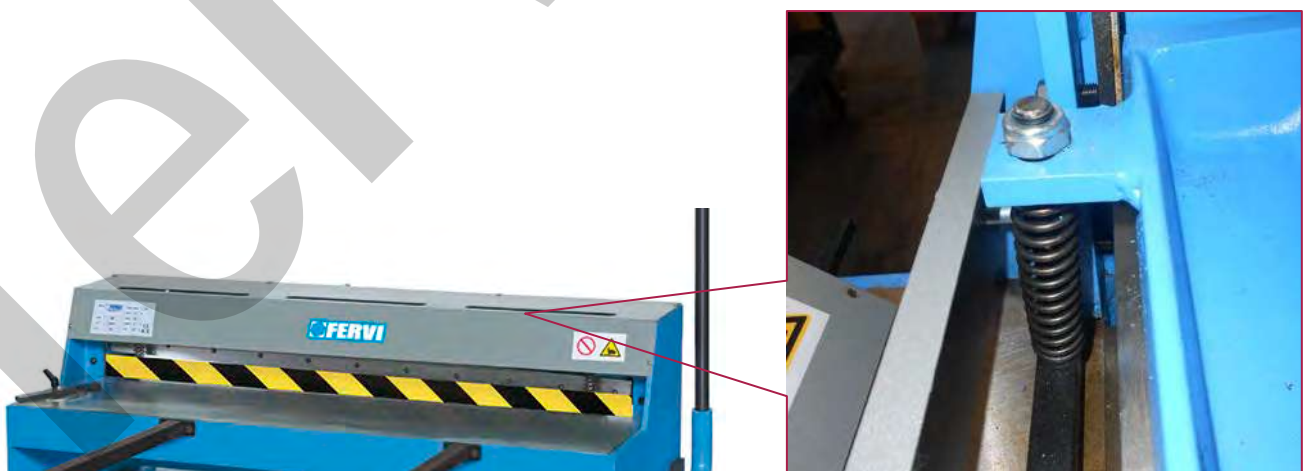
Figura 15 – Viti di regolazione della battuta ferma pezzo.
