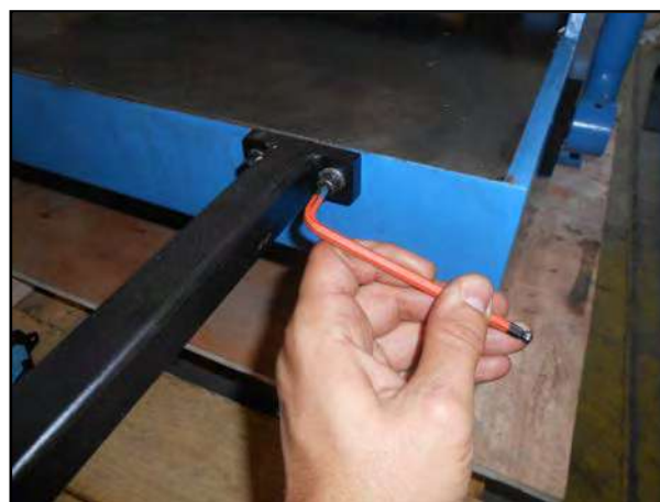
Figura 5 – Montaggio dei supporti anteriori della lamiera.
