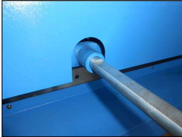
Figura 6 – montaggio dei supporti della battuta posteriore.
