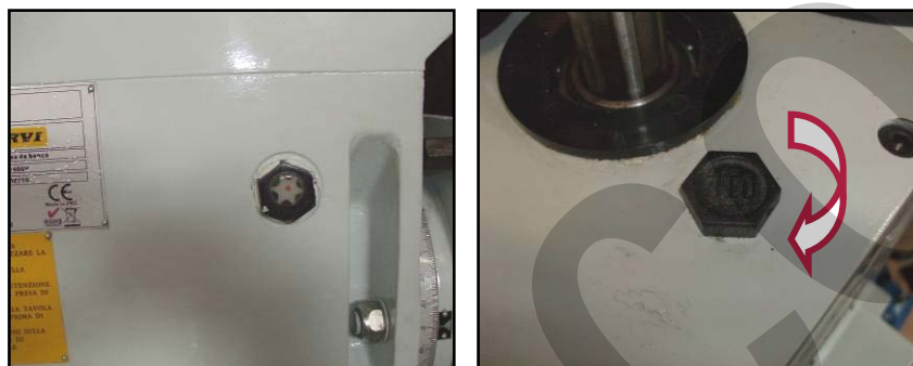
Figura 27 – Spia e tappo dell'olio lubrificante.
