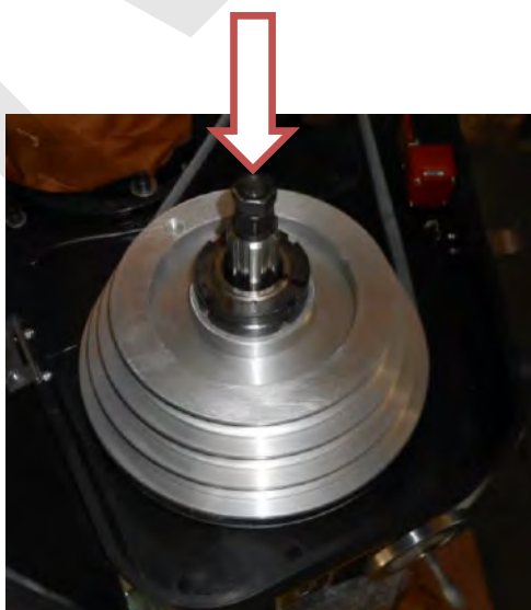
Figura 13 – Punto da colpire per eseguire lo smontaggio.
