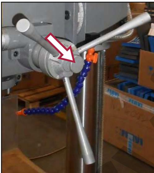
Per passare dal modo di avanzamento rapido, a quello di avanzamento calibrato, occorre agire sul pomello posto al centro della raggiera di avanzamento rapido del mandrino (Figura 13).
