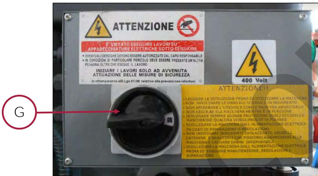
Figura 7 - Sezionatore generale dell'alimentazione elettrica.
