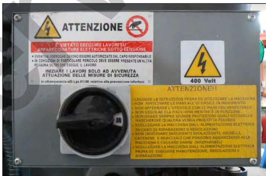
Figura 3 – Pittogrammi sul quadro elettrico della macchina.
