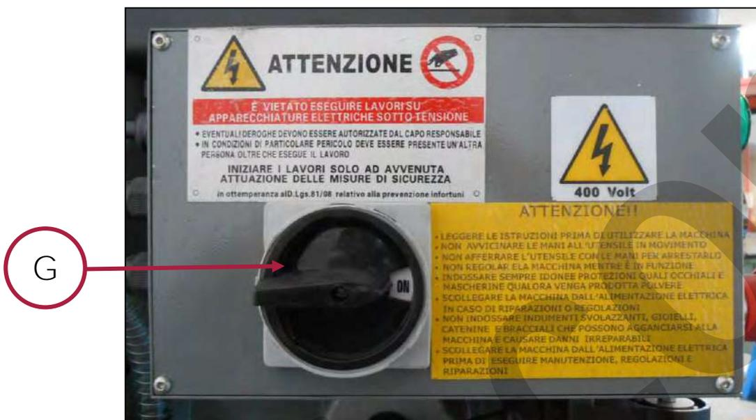
Figura 7 - Sezionatore generale dell'alimentazione elettrica.
