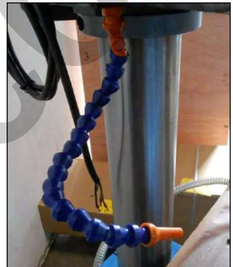
Figura 20 – Rubinetto di uscita del fluido refrigerante.
