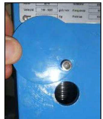
Figura 28- oblò di ispezione vite senza fine verticale.
