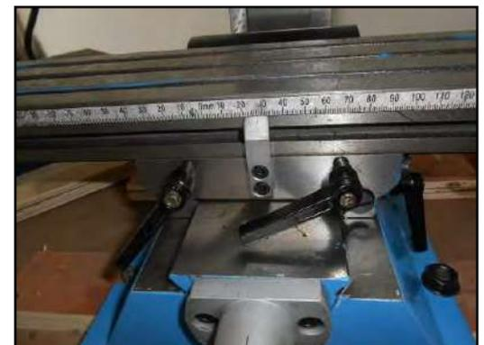
Figura 12 – Leve bloccaggio direzione longitudinale.
