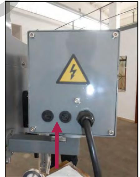
Figura 18 - Alloggiamenti fusibili di sicurezza.
