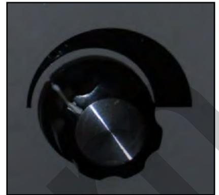
Figura 28 – Selettore velocità.
