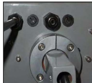
Figura 19 - Alloggi svitabili fusibili di sicurezza.
