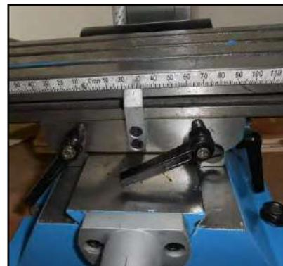
Figura 12 – Leve bloccaggio direzione longitudinale.
