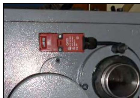
Figura 14 – Micro interruttore carter organi di trasmissione.
