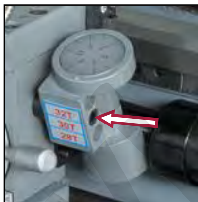
Figura 24 – Comparatore di filettatura e relativa tabella delle filettature
