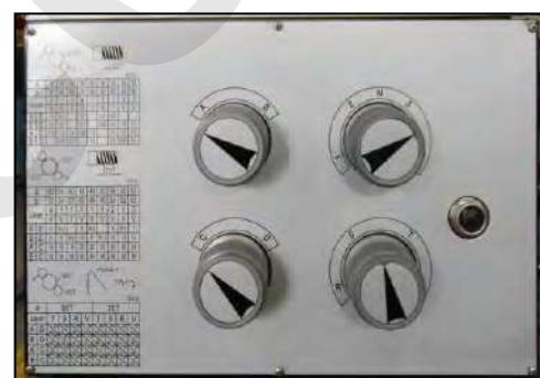
Figura 5 – Regolazione velocità avanzamenti automatici.
